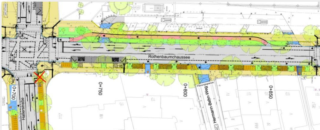
Diese Variante ähnelt der Minimalvariante. Zugunsten des Baumbestandes und der Sicherheit für den Radfahrer wird hier der Radverkehr schon vor dem Knoten Hallerstraße wieder auf die Fahrbahn zurückgeführt. In dieser Variante wird der Rechtsabbiegestreifen aufgelöst und aus der Geradeausspur eine Kombinationsspur Geradeaus / Rechts. Die Aufstelllänge des Linksabbiegestreifens bleibt unverändert, die Fahrstreifenbreiten werden angepasst um Platz für den westlichen Radfahrstreifen zu schaffen.
