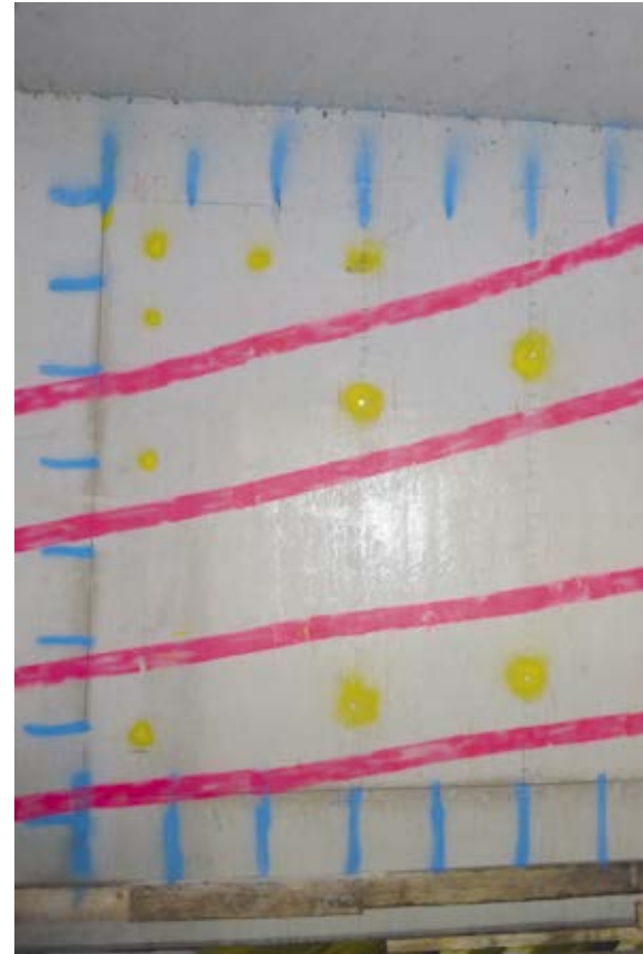
Messdurchführung mit multistatischem Messgerät und Markierung der Kernbohrungen (gelb) sowie der vorhandenen Spannglieder (pink) und der vorhandenen schlaffen Bewehrung (blau)
